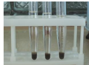
Рисунок 3 – Эффективность процесса обезвоживания отработанного ила при центрифугировании 1000 об/мин
